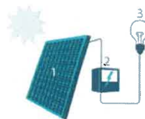
1 Zonnepaneel | 2 Omvormer | 3 Elektrische last(e)n
