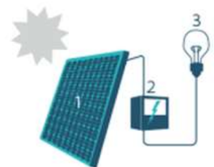
1. Zonnepaneel | 2. Omvormer | 3. Elektrische toestellen
