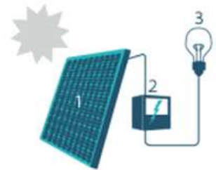
1. Zonnepaneel | 2. Omvormer | 3. Elektrische toestellen
