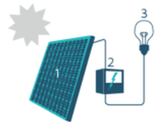
1. Zonnepaneel | 2. Omvormer | 3. Elektrische toestellen
